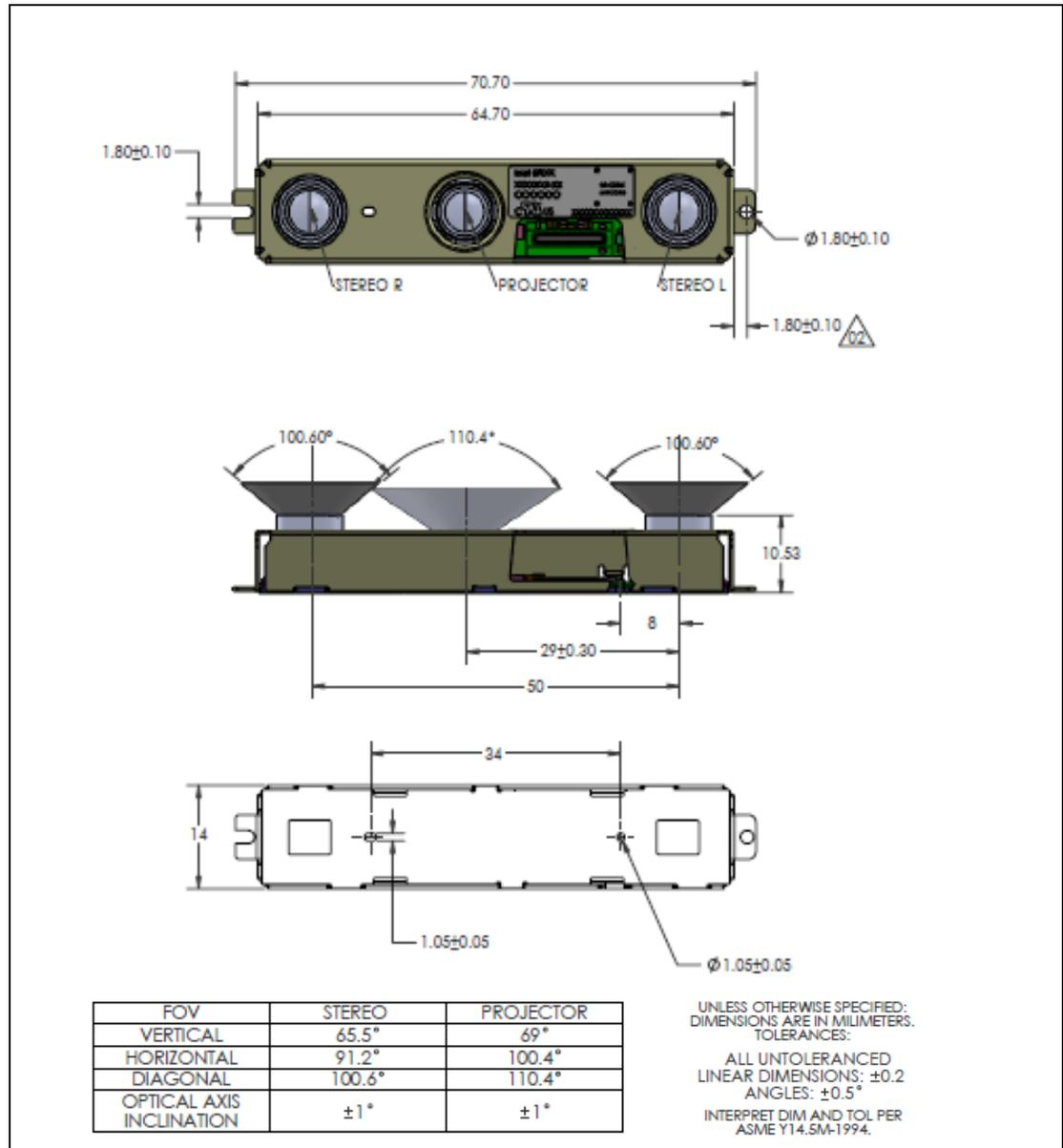
Figure 10-4. RealSense™ Depth Module D450
