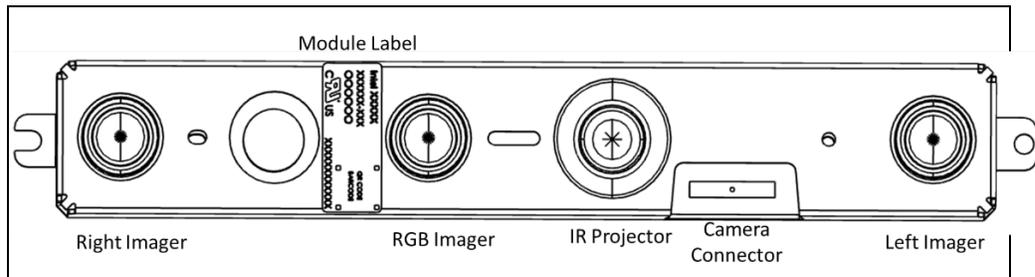
Figure 3-7. Stereo Depth Module (RealSense™ Depth Module D401)
