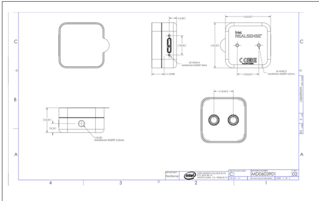
Figure 10-14. RealSense™ Depth Camera D456
