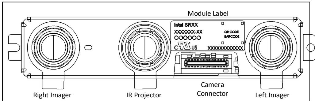
**Figure 3-6. Stereo Depth Module (RealSense™ Depth Module D450)**
