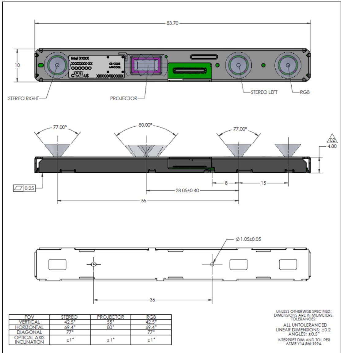
Figure 10-3. RealSense™ Depth Module D430
