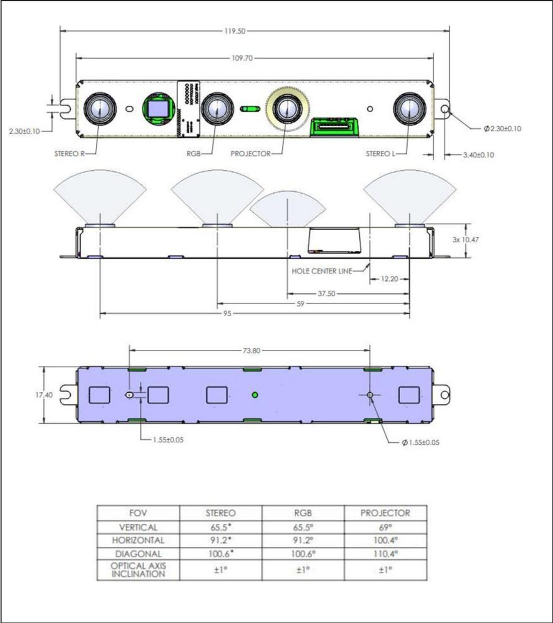
Figure 10-5. RealSense™ Depth Module D401
