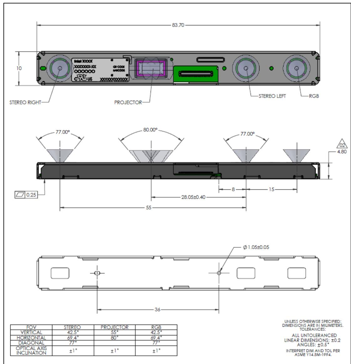
Figure 10-3. RealSense™ Depth Module D430
