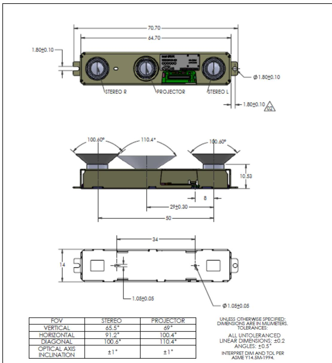
Figure 10-4. RealSense™ Depth Module D450
