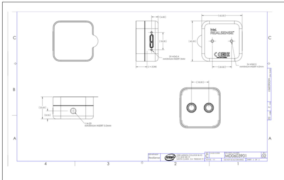
Figure 10-14. RealSense™ Depth Camera D456
