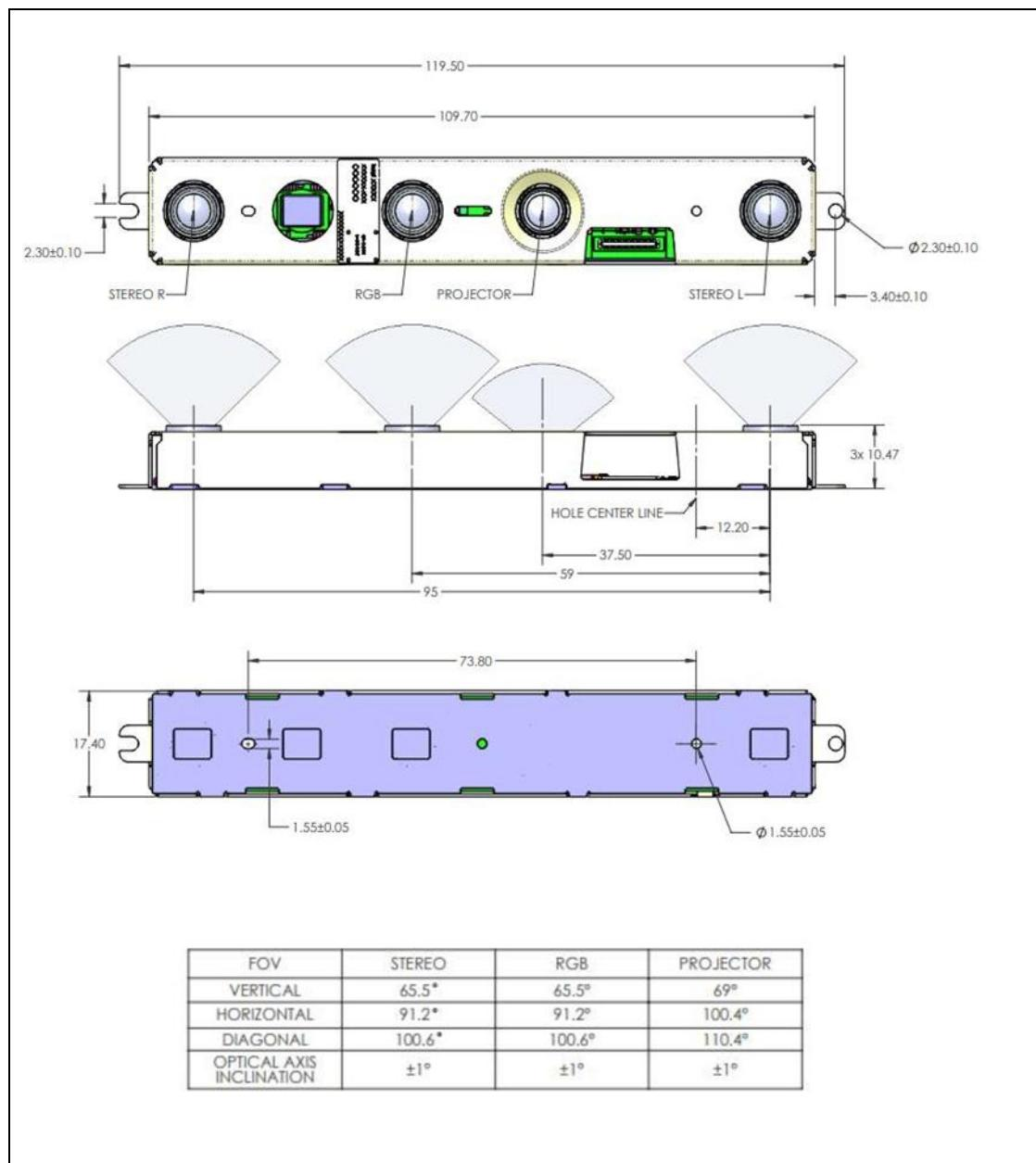
Figure 10-5. RealSense™ Depth Module D401
