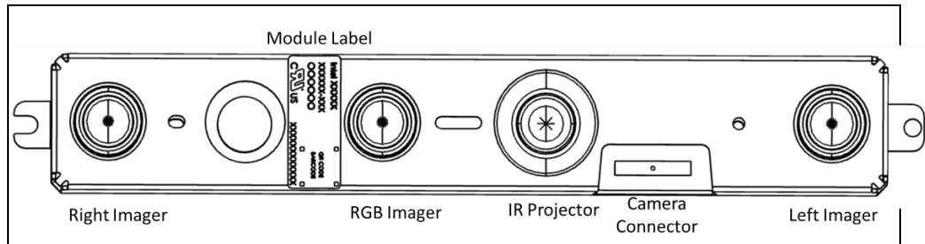
**Figure 3-7. Stereo Depth Module (RealSense™ Depth Module D401)**
